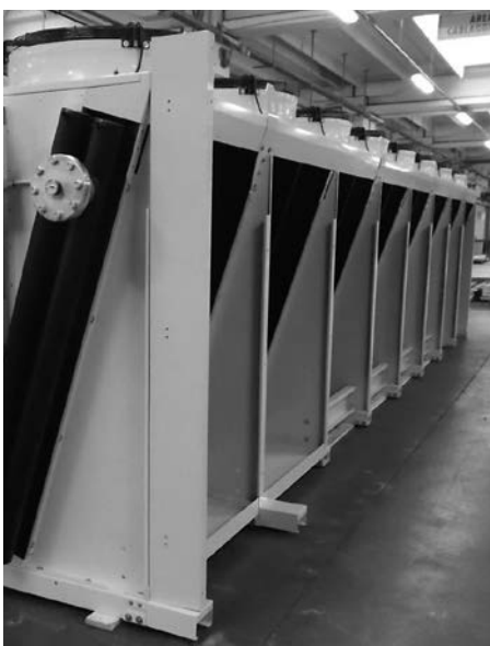
fig.12 - Posizionamento pannello verticale
