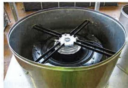
Luftkühler in Edelstahl mit Radialventilator mit 250 Pascal externe Pressung als Serienprodukt
