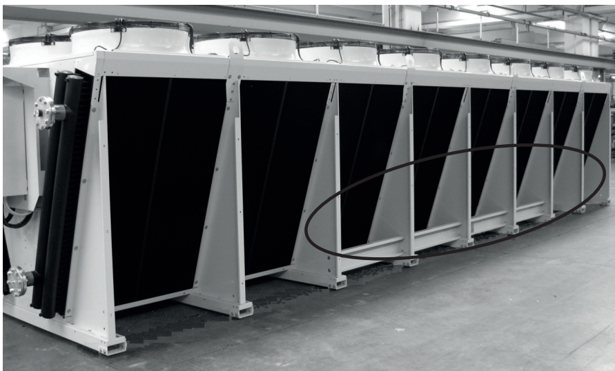
рис. 7 - Деталь поперечной балки модулей, используемой для перемещения и
