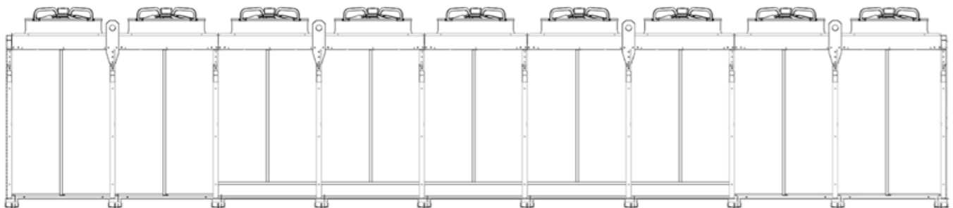
Abb. 5.4 - Schemata der Hebebügel für das Anheben mit Traversen, Serie JV.
